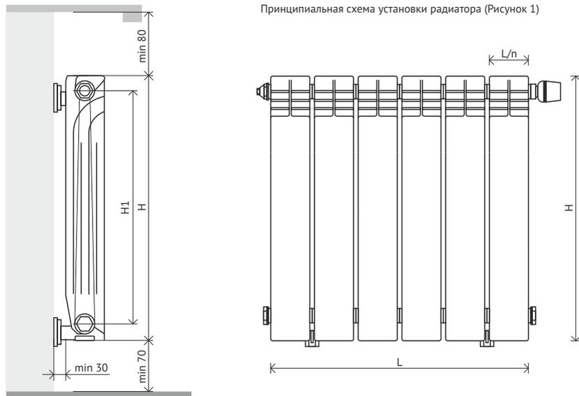
1.4 Изготовитель рекомендует (во избежание внешних механических повреждений, попадания строительного мусора в рабочие полости и т.д.) производить монтаж и подсоединение радиатора к трубопроводам без снятия защитной полиэтиленовой пленки.
